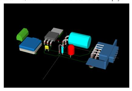
Il ne reste plus qu'à vérifier que la disposition des composants est satisfaisante avant d'imprimer les typons et de créer le fichier de perçage.
